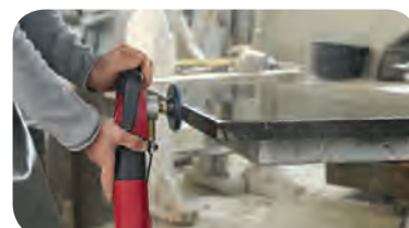
94200 100mm, M14, 16mm strato spugnoso, Velcro, 15,300 Max giri/min
